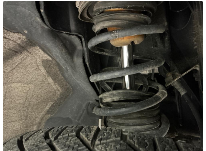
3.1 Støvmansjetter foran er defekt
