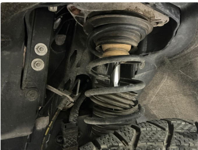
3.1 Støvmansjetter foran er defekt
