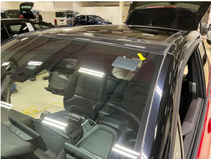
1.2 Slitt frontrute etter viskere. Steinsprutskade i venstre øvre hjørne, reparert.
