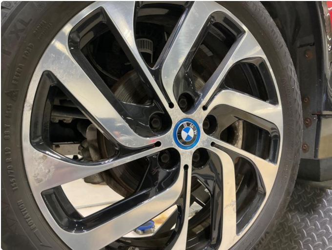
1.1 Vinterfelger noe korrodert.
