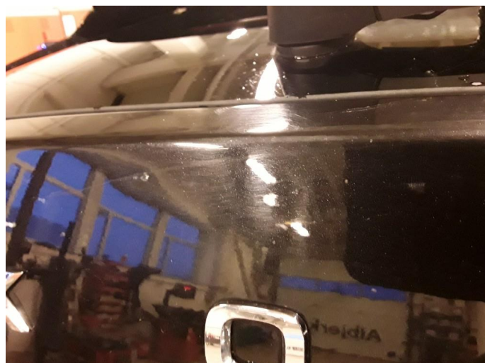
1.2 Småbulker med lakksår.
