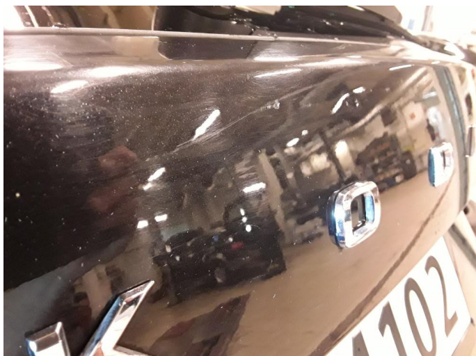
1.2 Småbulker med lakksår.
