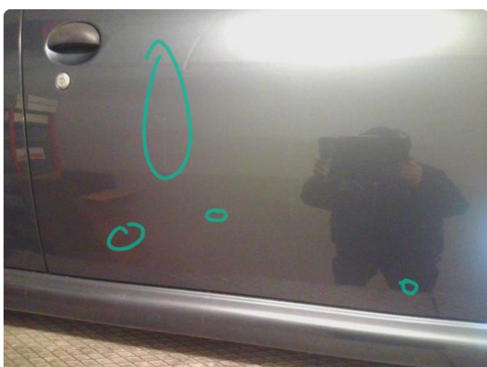
2.3 Steinsprut med rust
