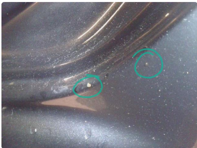
2.5 Steinsprut med rust
