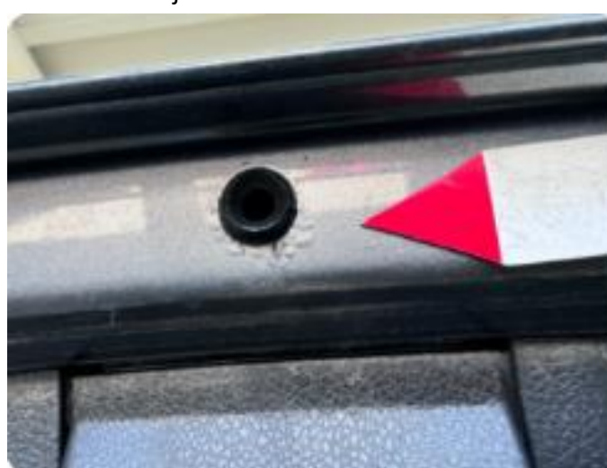
1.3 Noe korrosjon på bakluke.
