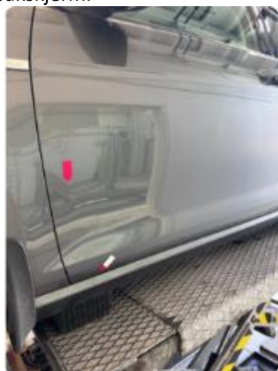
1.1 Noe riper innsteg venstre bak, Noe korrosjon og småbulker på alle dører, Korrosjon mellom fanger og bakskjerm begge sider, Korrosjon venstre bakskjerm.
