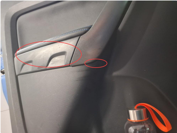
2.1 Skadet/merker etter utstyr
