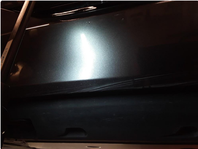
1.2 Noen riper nedre list på høyre bakdør.
