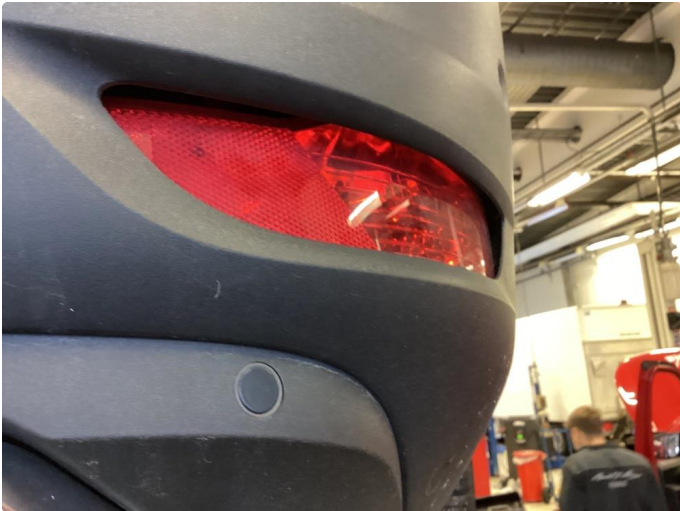
1.1 Tåkelys - defekt/sprukket glass
