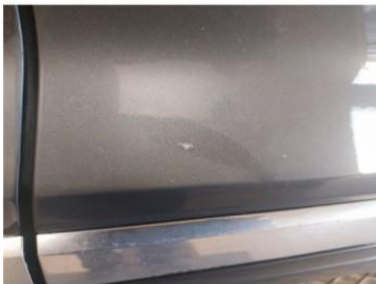
1.2 Steinsprut med rust
