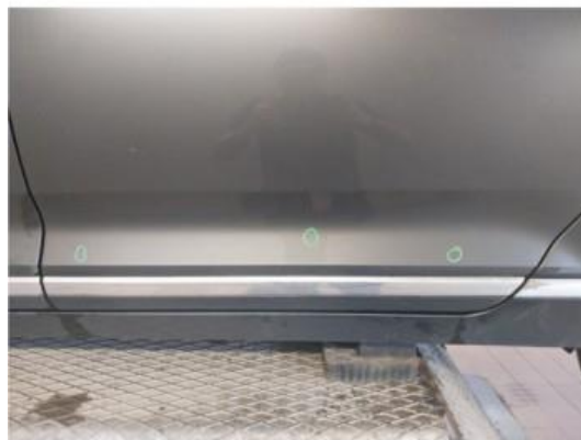
1.2 Steinsprut med rust
