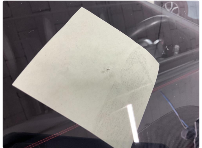
1.1 Steinsprutskade h. side frontrute. Denne er reparert.
