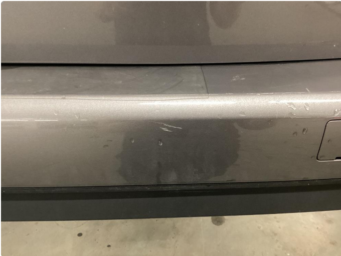
1.1 Noen riper i innlastningsone varerom
