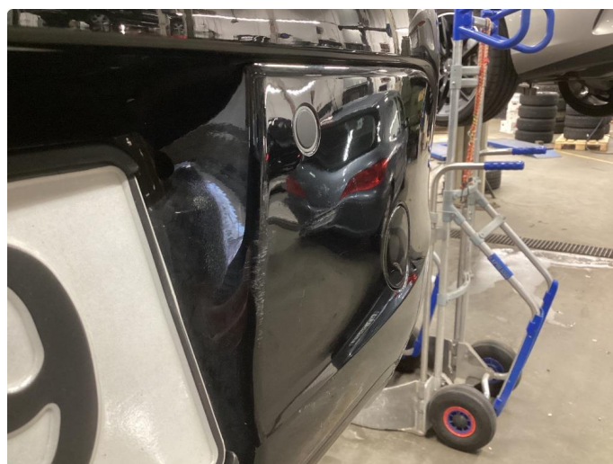
1.2 Liten deformering i plast på bakfanger. Ripe som er utbedret med flekklakk
