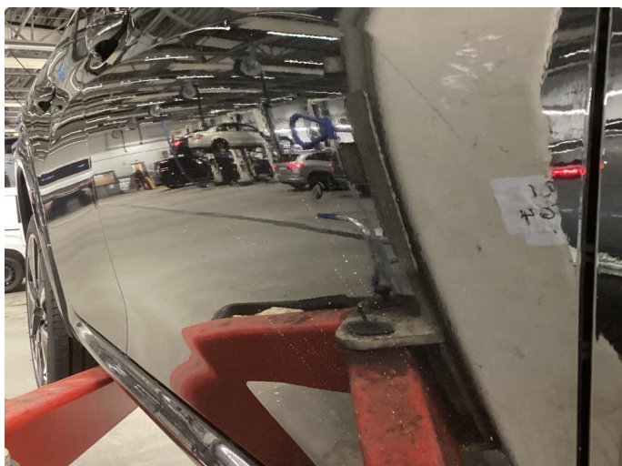
1.1 Lite synlig bulk uten lakkskade
