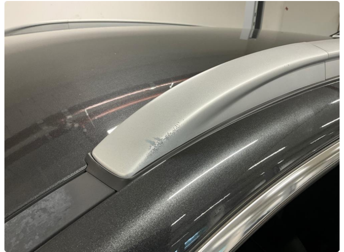
1.2 Noe lakksår deksel i forkant av v. takrail
