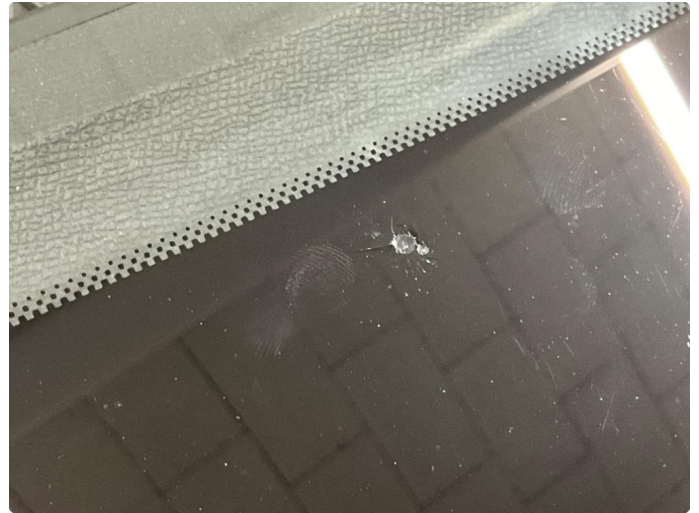
1.2 Steinsprutskade nede h. side frontrute. Denne er reparert.
