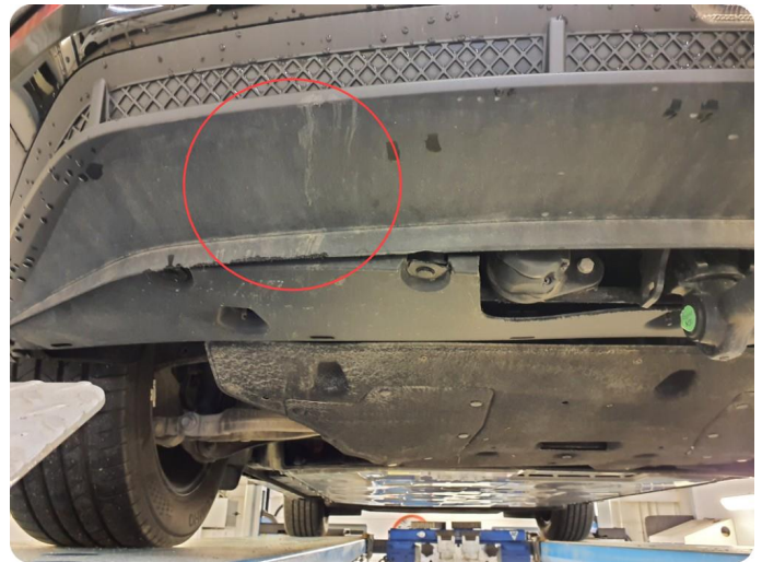
2.3 Ripe(r) ned til grunning Subbeskade og løs innfesting plate under
