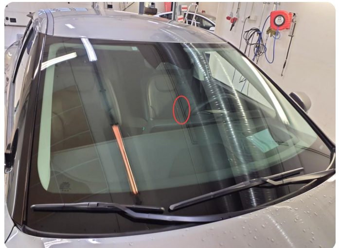
2.4 Steinsprut med sprekk
