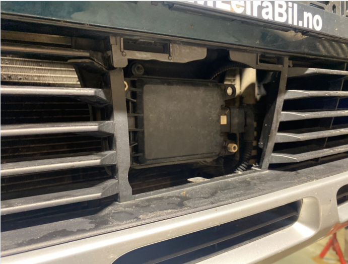
2.8 Litt knust i nederste grill, mangler deksel
