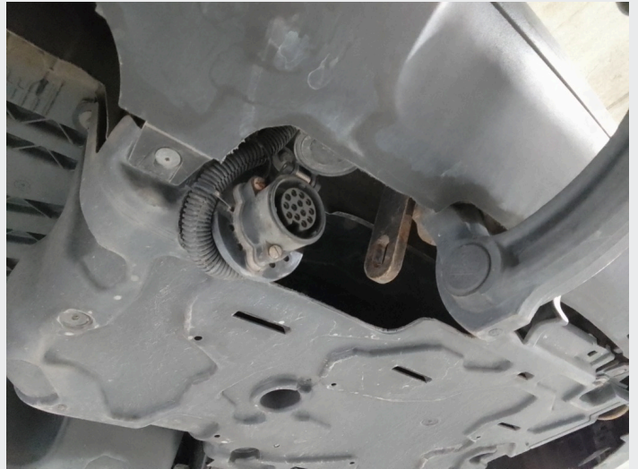
2.21 Ikke optimal utskjering på fanger, får ikke lokk lett på og av
