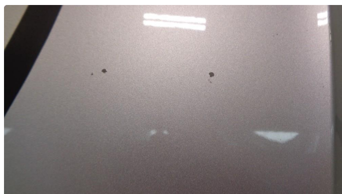
1.2 En del steinsprut panser
