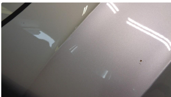
1.2 En del steinsprut panser
