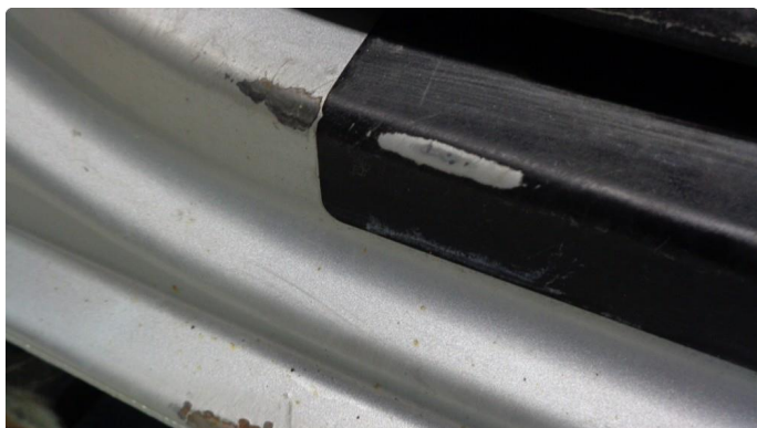
1.7 Innsteg venstre foran + innside dør under dørtrekk - blærer
