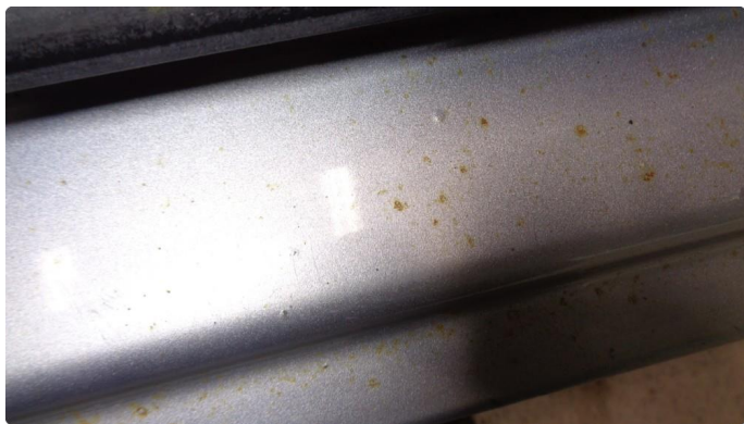
1.8 Innsteg venstre bak - blærer/slitt lakk + bulk
