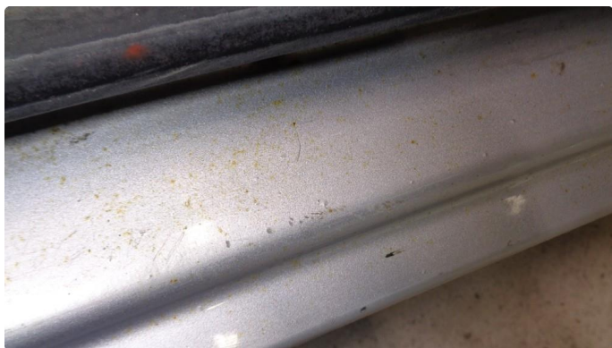
1.8 Innsteg venstre bak - blærer/slitt lakk + bulk
