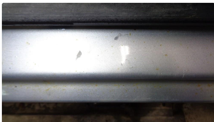
1.8 Innsteg venstre bak - blærer/slitt lakk + bulk
