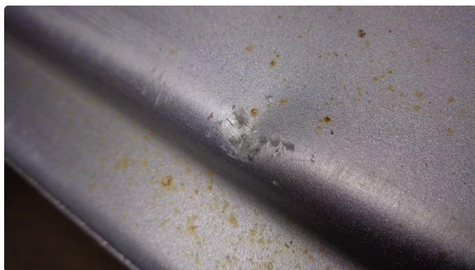
1.6 Innsteg høyre bak blærer og lakkflass samt en bulk
