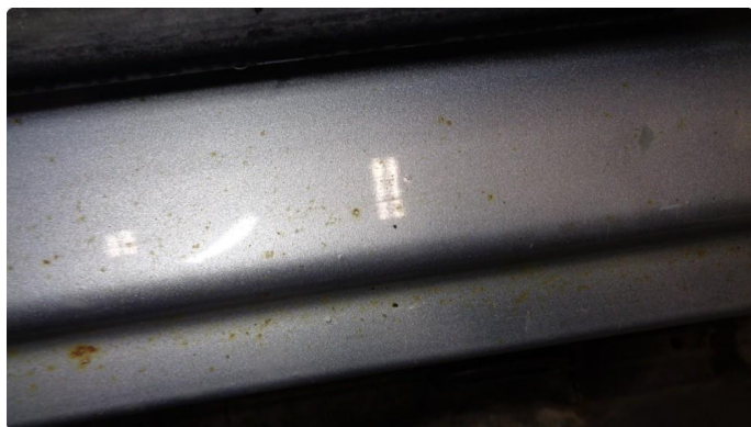
1.8 Innsteg venstre bak - blærer/slitt lakk + bulk
