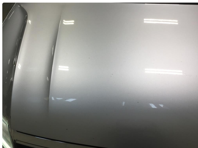
1.2 En del steinsprut
