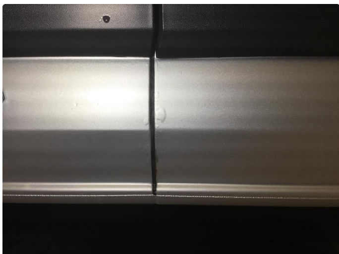
1.1 Venstre bakskjerm - blærer/korrosjon
