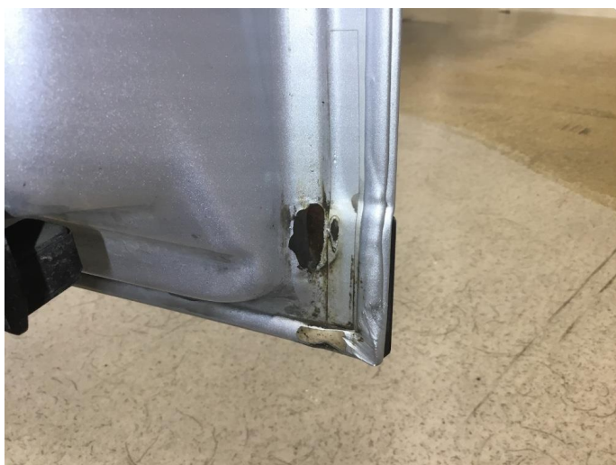
1.6 Rust i fals
