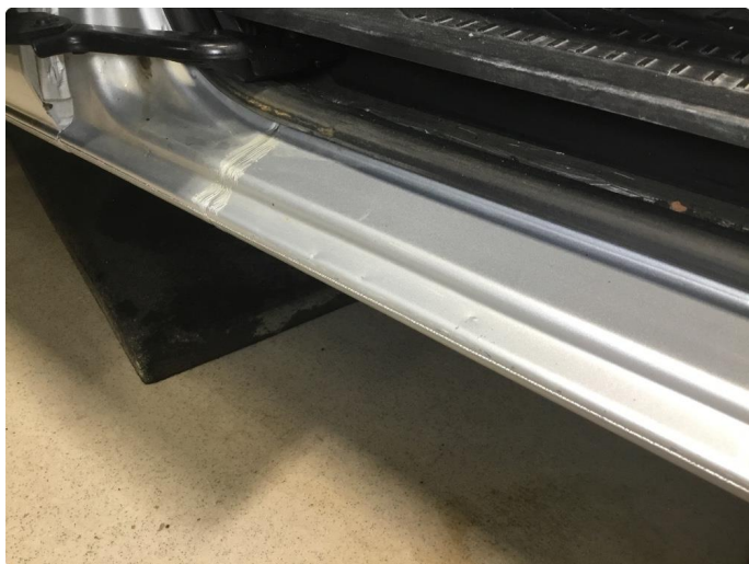
1.9 Høyre skyvedør - bulker, sår og slitasje
