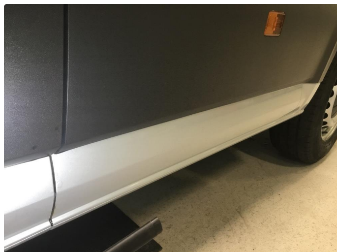
1.1 Venstre bakskjerm - blærer/korrosjon
