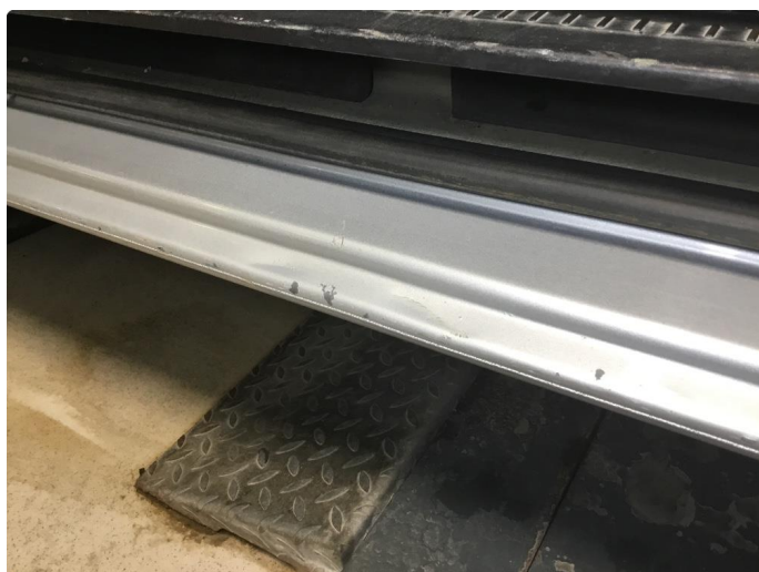
1.9 Høyre skyvedør - bulker, sår og slitasje
