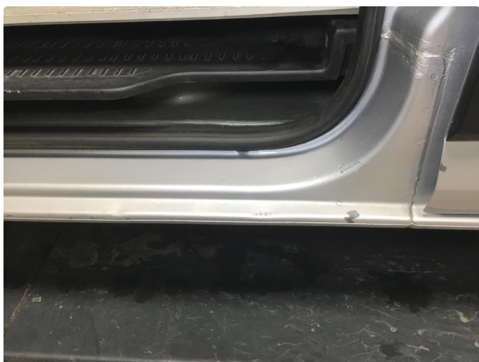
1.9 Høyre skyvedør - bulker, sår og slitasje
