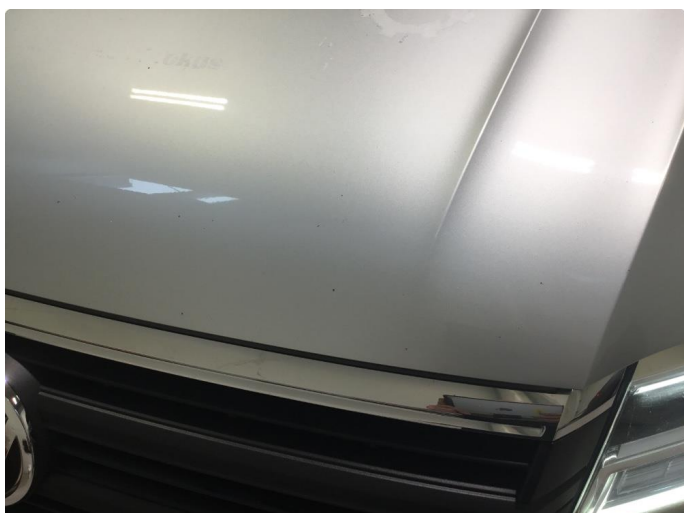
1.2 En del steinsprut
