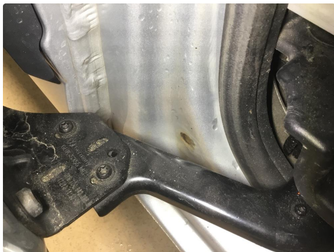
1.9 Høyre skyvedør - bulker, sår og slitasje
