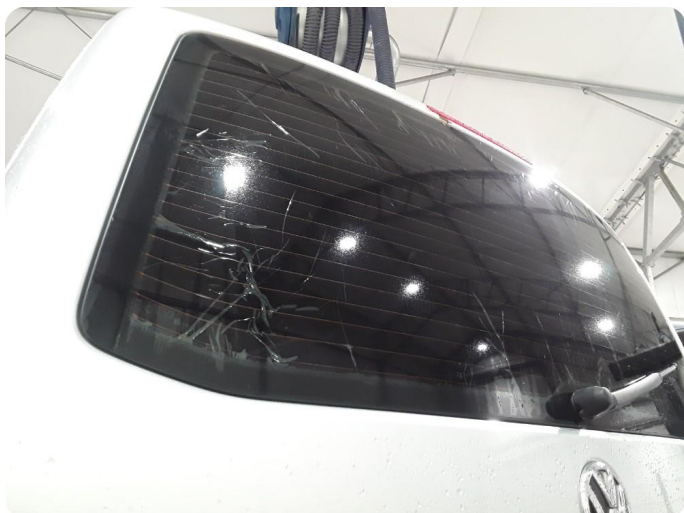
3.13 Ulovlig sotet/solfilm /skadet solfilm på bakluke og høyre bakvindu
