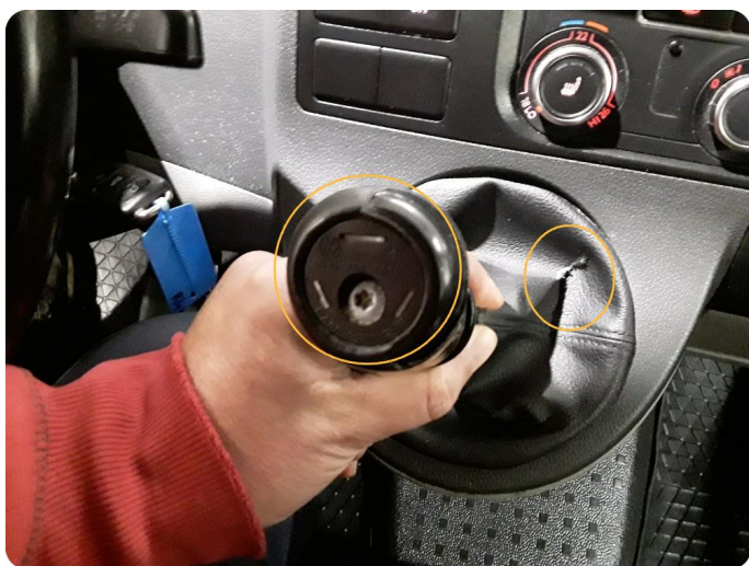
8.1 Girmansjett slitt/defekt -og deksel mangler
