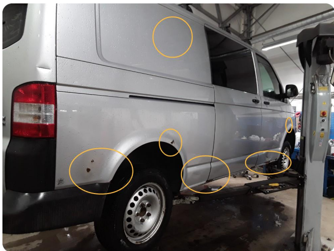
3.7 Generelt mye rust -ink riper og bulker
