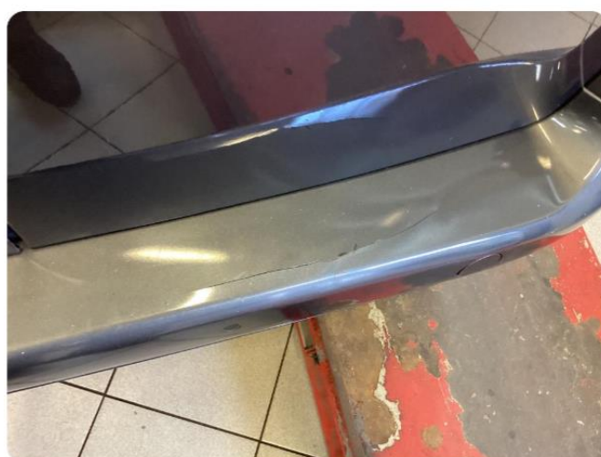
1.3 Sprekk i støtfanger bak.
