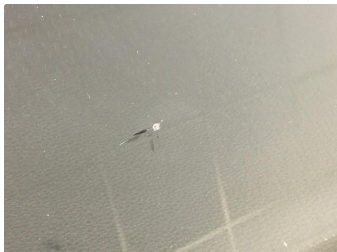
1.1 Steinsprut med sprekk utenfor synsfelt
