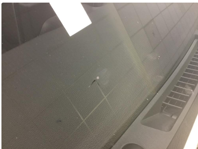
1.1 Steinsprut med sprekk utenfor synsfelt
