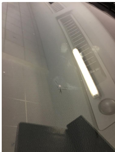
1.1 Steinsprut med sprekk utenfor synsfelt
