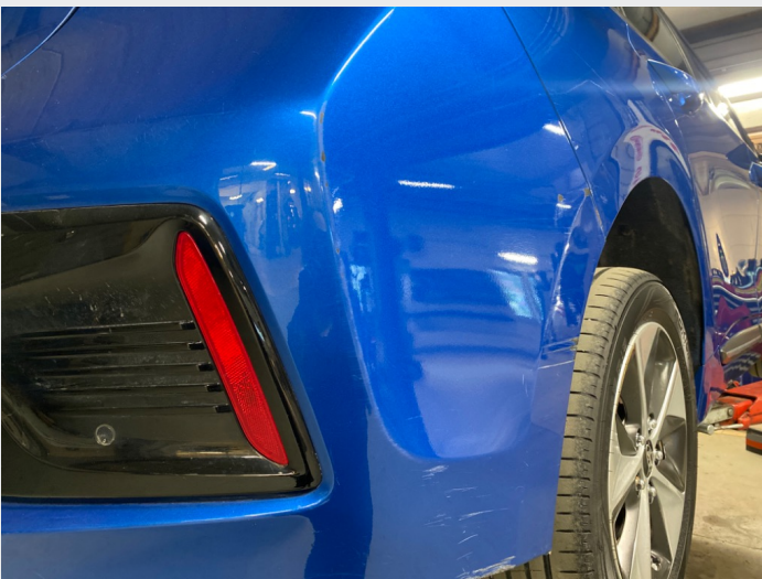
2.8 Oppstripet høyre bakfanger, knekt fester på innside
