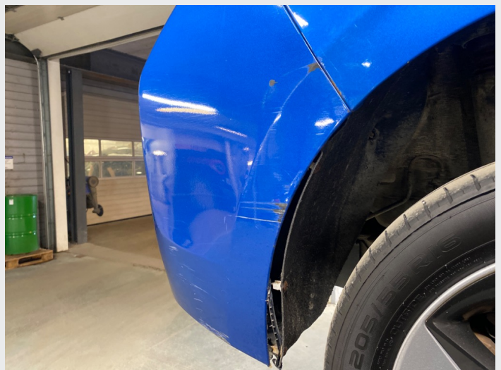
2.8 Oppstripet høyre bakfanger, knekt fester på innside
