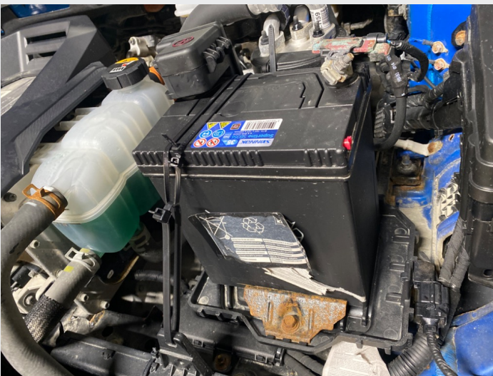
5.2 Batteri ser for lite ut til bil, kan ikke festes med egnet feste, stripsset fast
