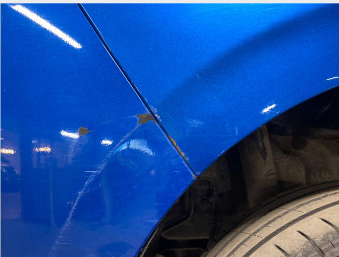
2.7 Rust høyre bakskjerm
