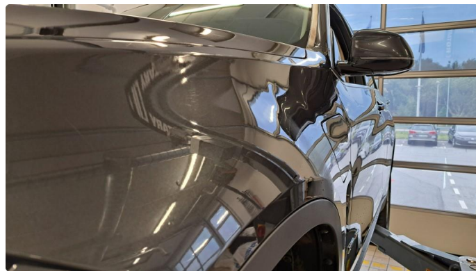
1.11 Ujevn overflate. Plast.
