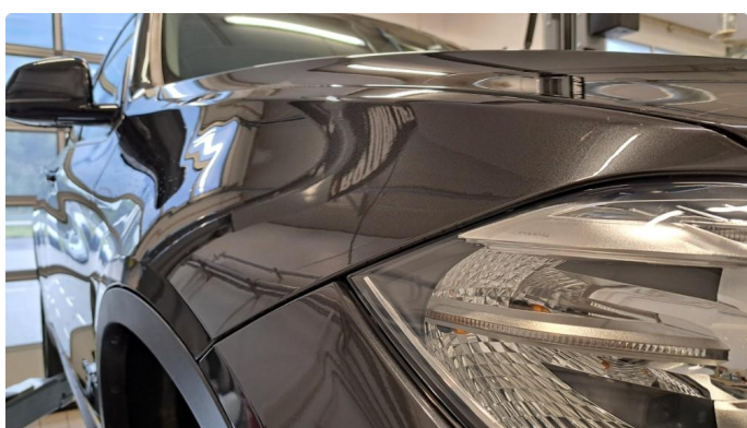
1.11 Ujevn overflate. Plast.
