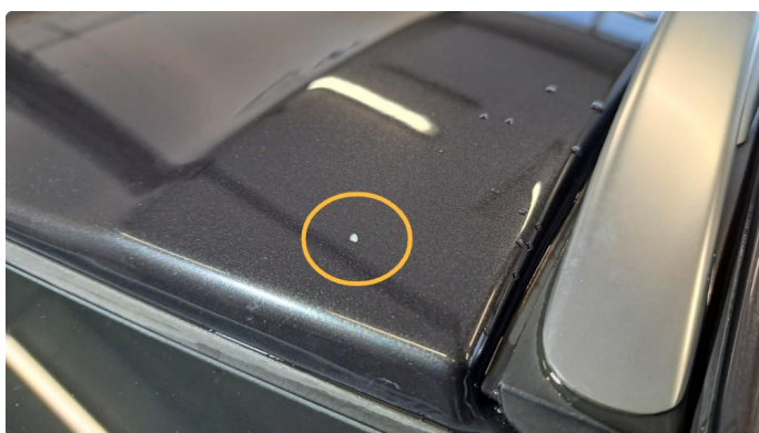
1.15 Steinsprut. og noen riper.
