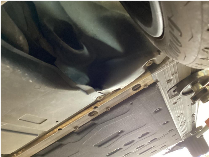
1.1 Liten bulk/deformering på plastinnerskjerm v.s
