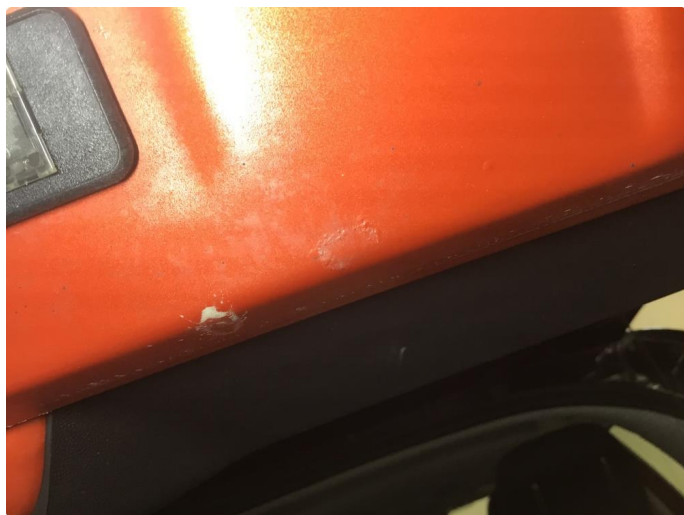
1.9 Bakluke - rustblærer innvendig
