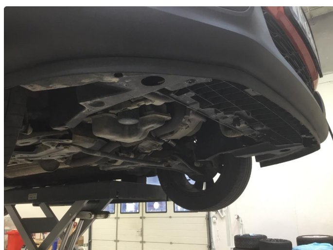
1.2 Beskyttelsesplate under motor mangler
