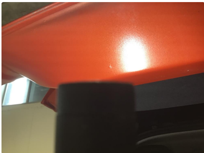
1.9 Bakluke - rustblærer innvendig
