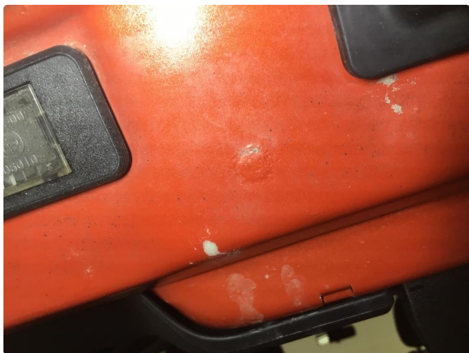
1.9 Bakluke - rustblærer innvendig
