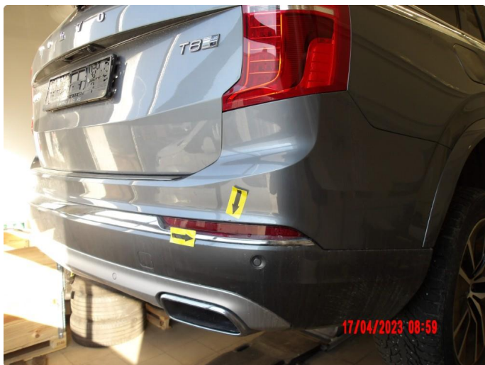
1.4 Ripe(r) ned til grunning
