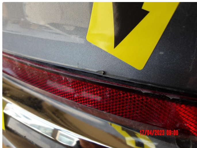
1.4 Ripe(r) ned til grunning
