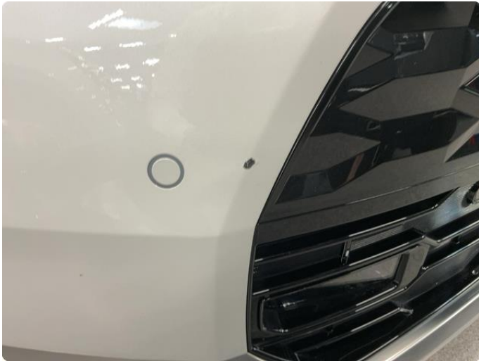
1.1 Ripe(r) ned til grunning, samt steinsprut.
