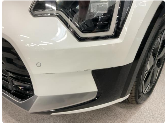
1.1 Ripe(r) ned til grunning, samt steinsprut.
