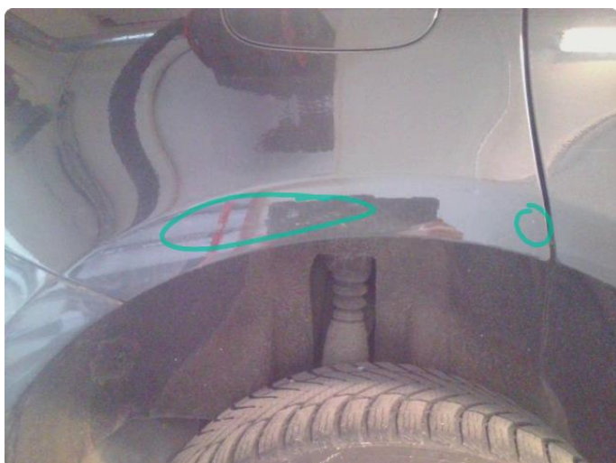
1.3 Steinsprut med rust
