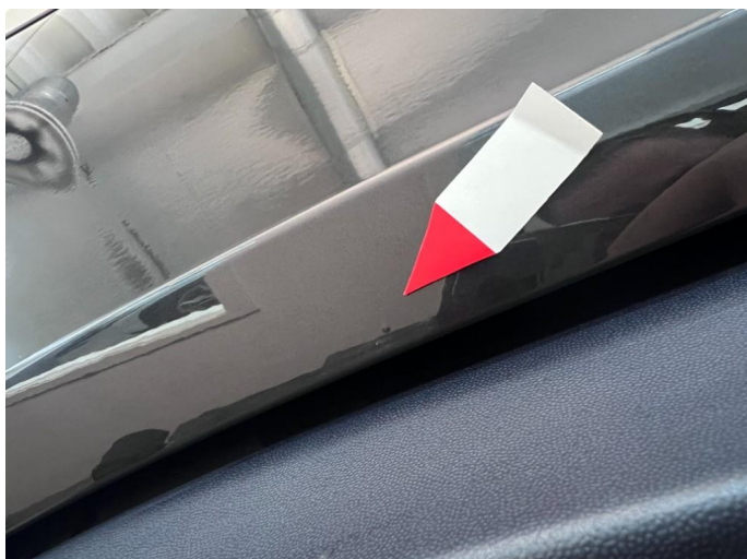
1.1 Steinsprut med rust
