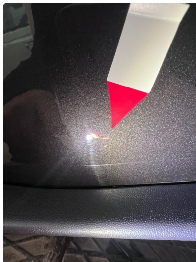
1.1 Steinsprut med rust
