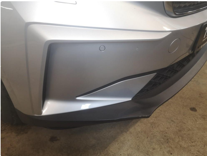
1.1 Mindre skade på lakkert del, samt nedre del av støtfanger foran.
