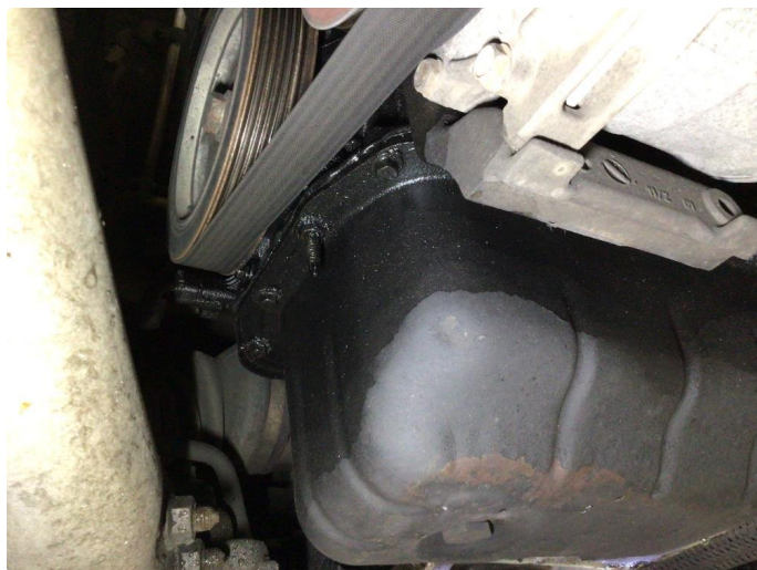
4.2 Oljelekkasje fra motor
