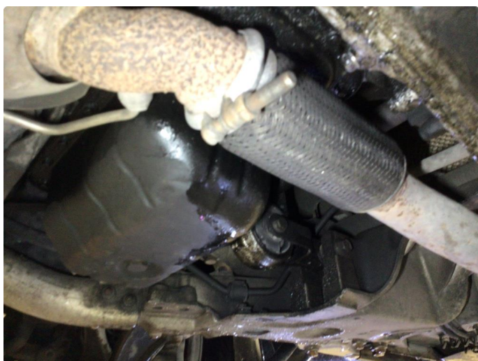
4.2 Oljelekkasje fra motor
