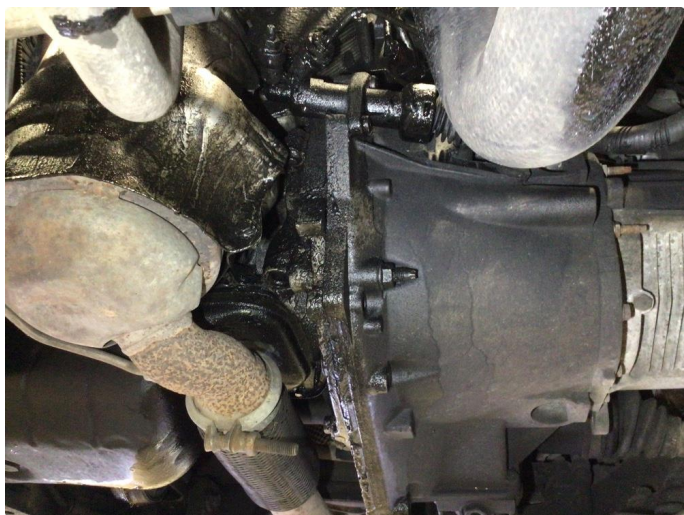
4.2 Oljelekkasje fra motor
