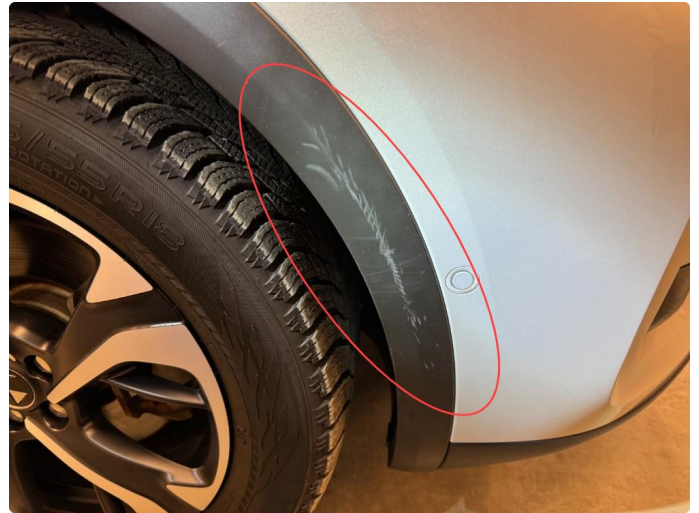
1.2 Lister skadet/mangler - Ripe på plastlist, hjulbue.
