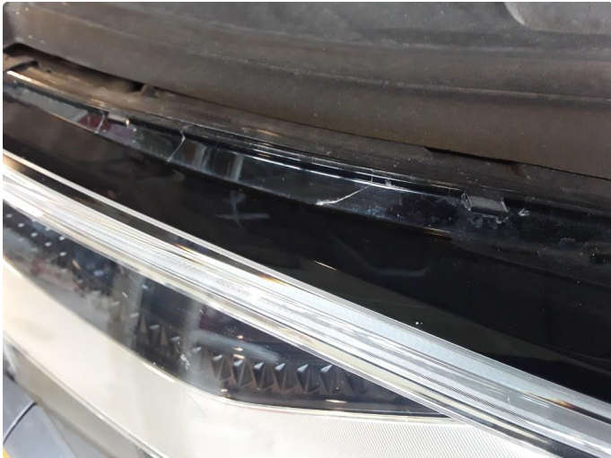
2.1 Noe sprukket glass i venstre og høyre hovedlampe foran.
