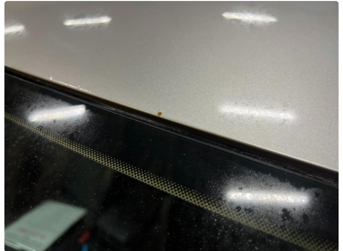
2.2 Steinsprut med rust
