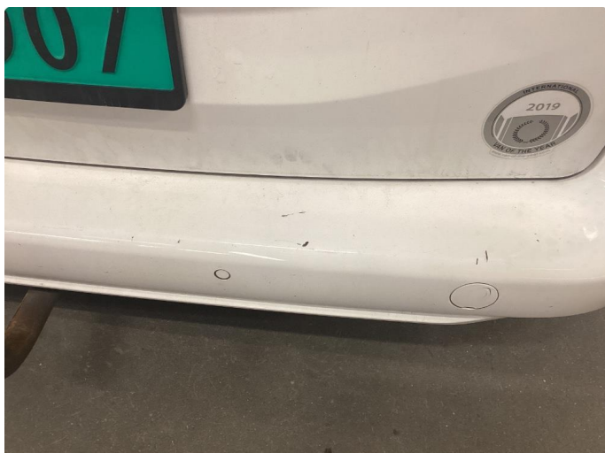
1.1 Riper innlastingsone bakfanger. Flekkes før levering
