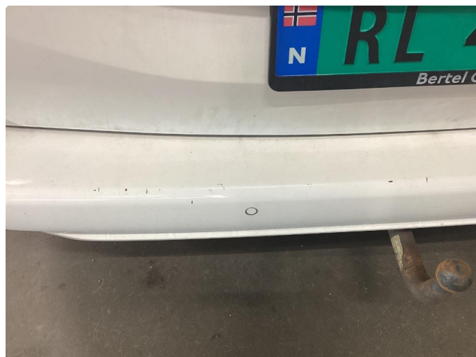
1.1 Riper innlastingsone bakfanger. Flekkes før levering
