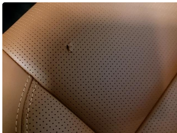
3.1 Skade på setetrekk
