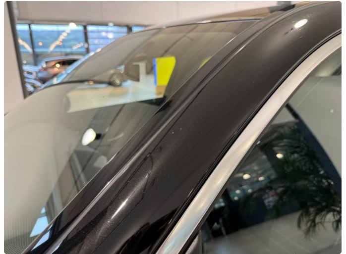
1.2 2 små steinsprut på stolpe
