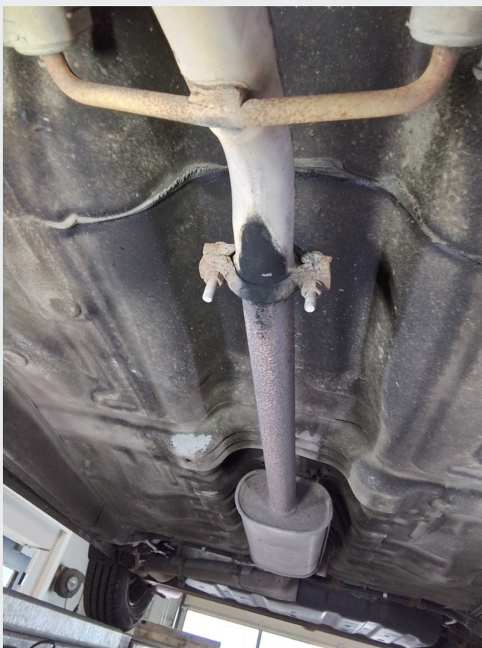
5.6 Eksos lekk i skjõt under bil
