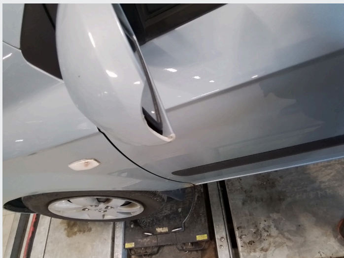
2.12 Skade på speildeksel
