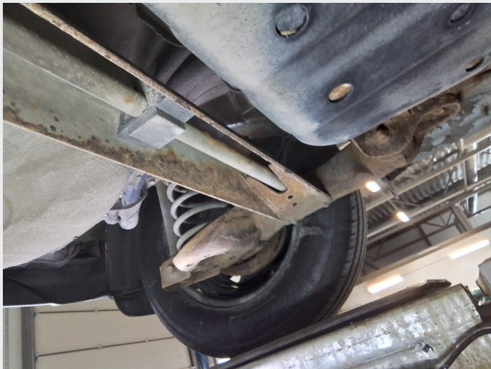
8.4 Mye overflaterust på travers foran og bak
