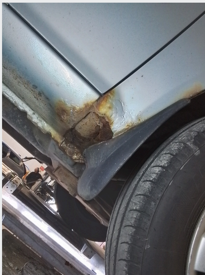
2.7 Rusthull i nedkant av skjerm hf
