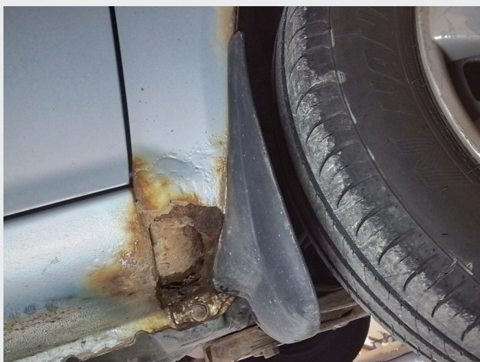
2.7 Rusthull i nedkant av skjerm hf
