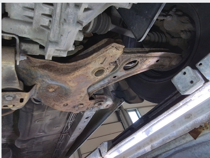
8.4 Mye overflaterust på travers foran og bak
