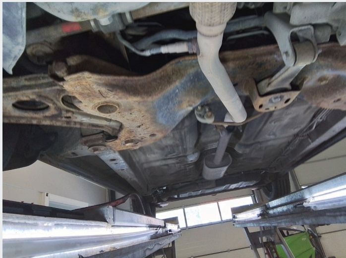
8.4 Mye overflaterust på travers foran og bak
