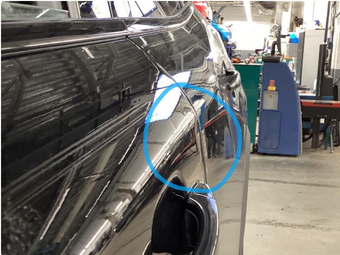
1.1 Små bulker uten lakkskade i førerdøren
