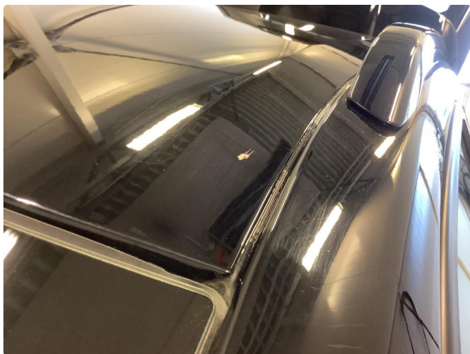
1.3 Liten steinsprang tak flekket
