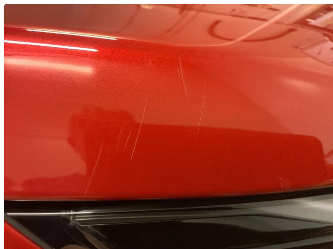
1.1 Steinsprang panser flekket
