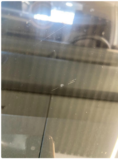
1.5 Steinsprut med sprekk
