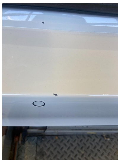
1.4 Ripe(r) ned til grunning
