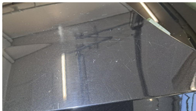
1.1 Noen riper og steinsprut.
