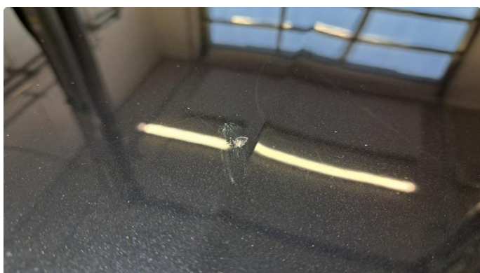
1.1 Noen riper og steinsprut.
