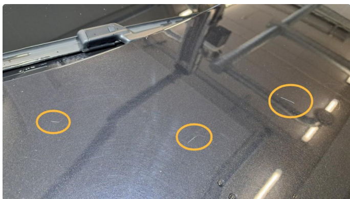
1.1 Noen riper og steinsprut.
