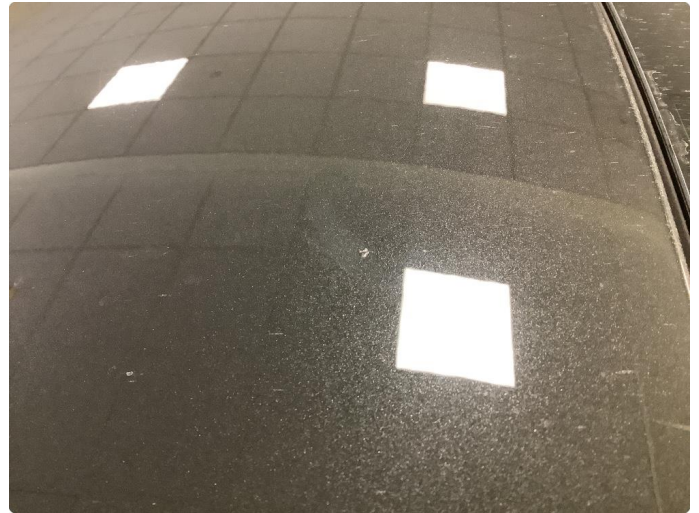
1.1 Steinsprut med rust på tak er flekket
