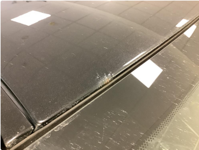
1.1 Steinsprut med rust på tak er flekket
