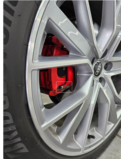
2.1 Noe lakkflass på bremsecalipere bak, calipere er blitt lakkert (ikke originalt fra Audi)
