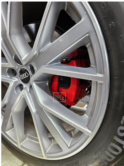
2.1 Noe lakkflass på bremsecalipere bak, calipere er blitt lakkert (ikke originalt fra Audi)
