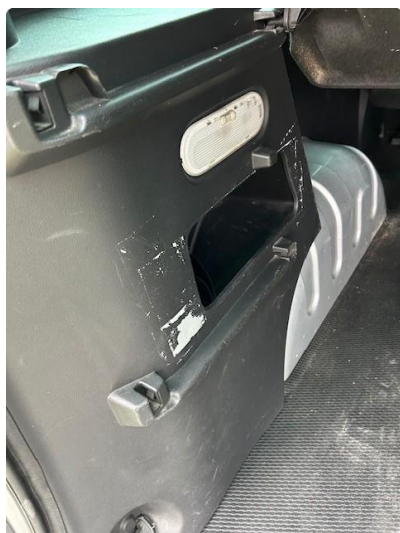
3.2 Manglende deksel i bagasjerom
