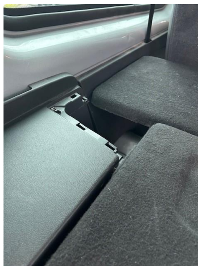
3.2 Manglende deksel i bagasjerom
