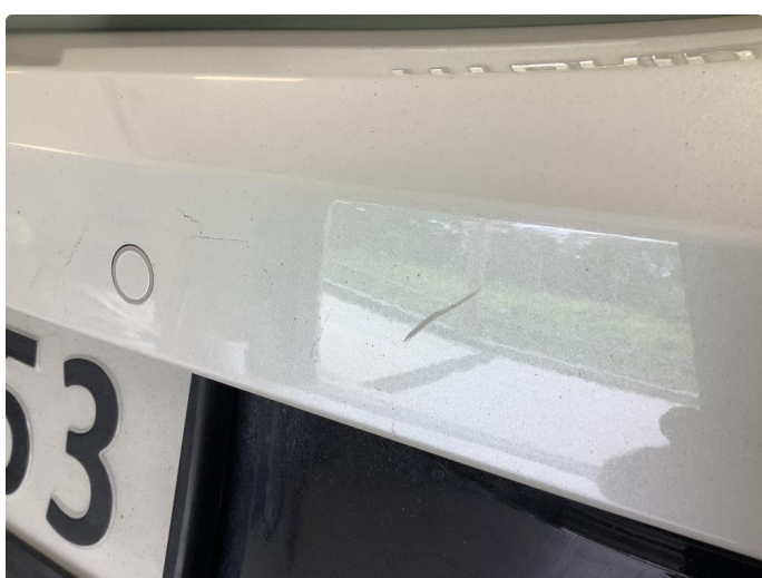
1.1 Noen riper og småbulker
