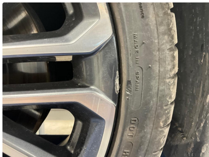
1.1 Kantkjørt felg h. bak og v. side foran (sommer) og noe sår i en vinterfelg
