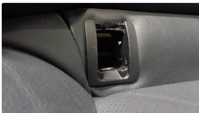
2.1 Isofix deksel høyre bak mangler/knekt
