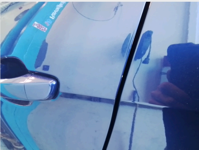
2.5 Små lakkskader på dørkanter alle dører
