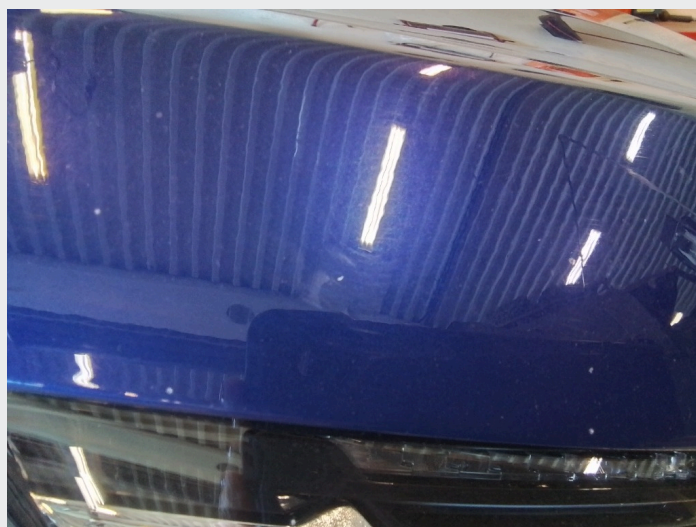
2.8 Steinsprutskader fremre støtfanger/grill
