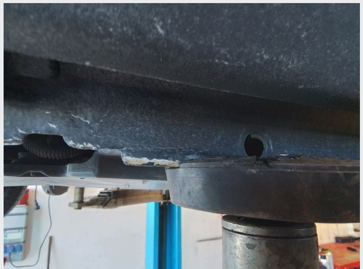
2.2 Avflassing ved kanaler høyre side
