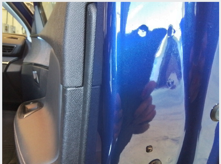
2.5 Små lakkskader på dørkanter alle dører
