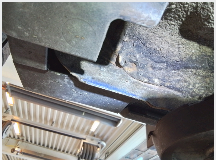
2.2 Avflassing ved kanaler høyre side
