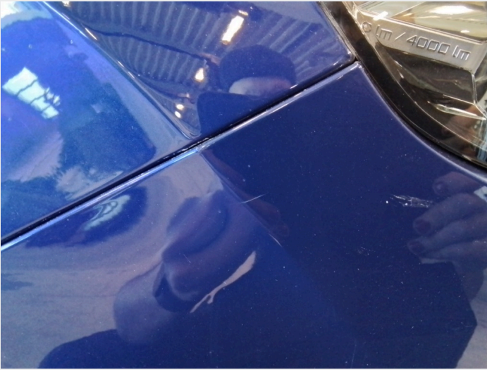
2.8 Riper fremre støtfanger høyre side
