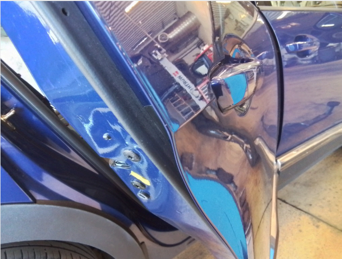
2.5 Små lakkskader på dørkanter alle dører
