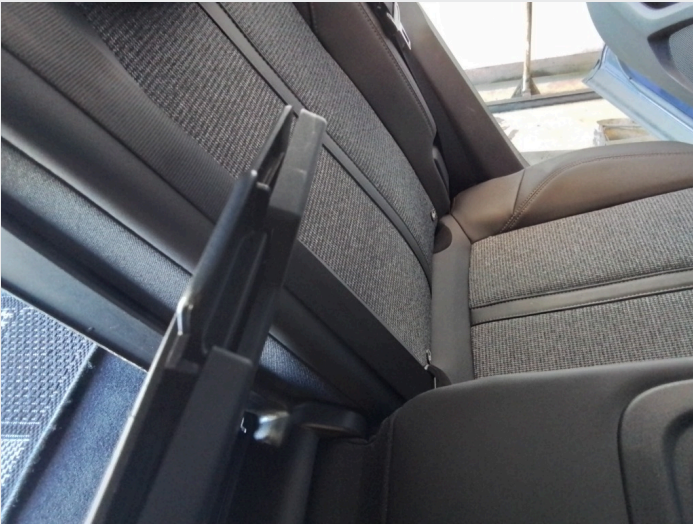
4.5 Luke til bagasjerom i midtre seterygg bak er ødelagt
