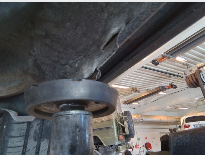
2.2 Avflassing ved kanaler høyre side
