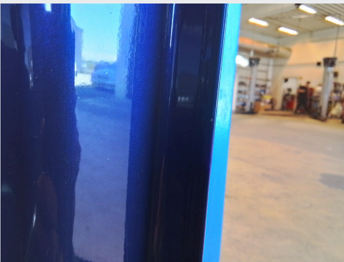
2.5 Små lakkskader på dørkanter alle dører
