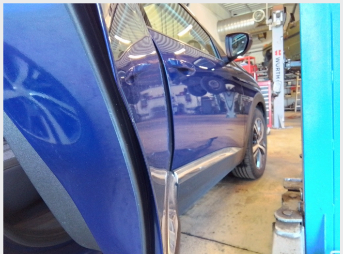
2.5 Små lakkskader på dørkanter alle dører
