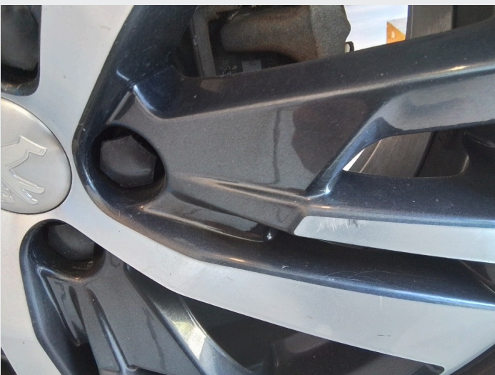
2.18 Små lakkskader på alle felger
