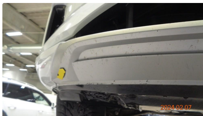
1.2 Skrubbskader underkant støtfanger foran.
