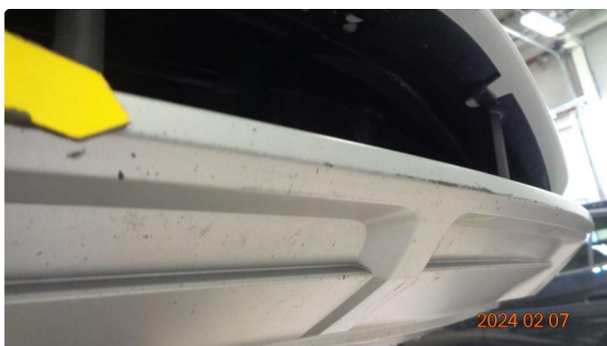
1.2 Skrubbskader underkant støtfanger foran.
