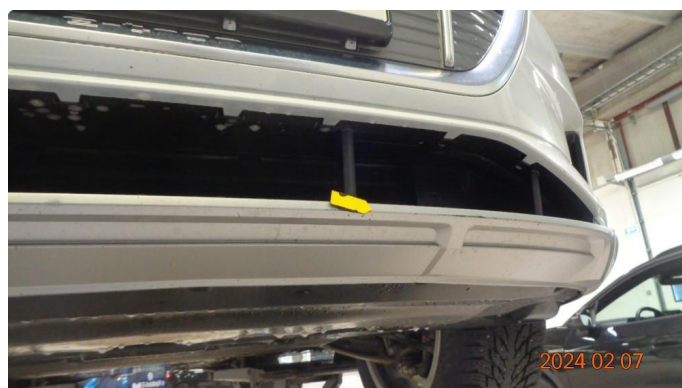
1.2 Skrubbskader underkant støtfanger foran.
