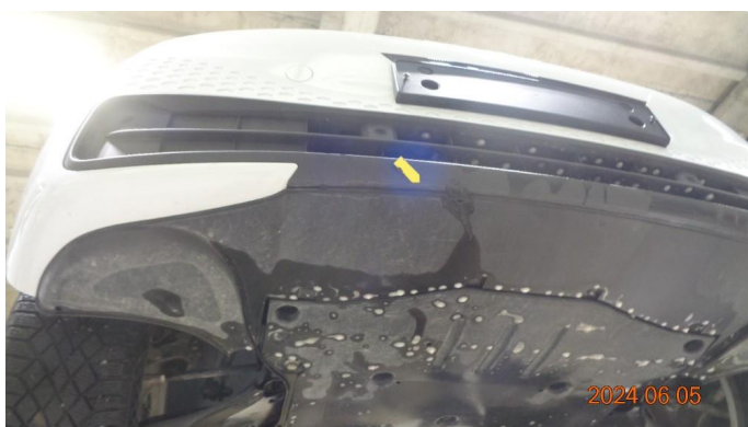
1.1 Skrubbskader underkant med hull støtfanger foran
