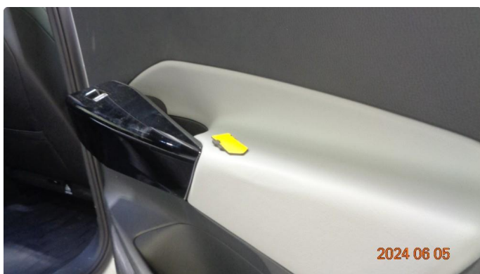
2.1 Slitemerke innvendig dørtrekk høyre bakdør
